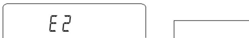
亮度计发生故障，需要维修。请联系最近的柯尼卡美能达授权维修中心。
