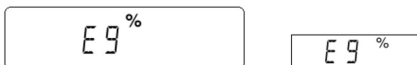
现有的测量将导致出现超过 999900 (cd/m<sup>2</sup> 或 fL) 的绝对亮度值或超过 999.9% 百分比亮度值。请检查参考亮度值并再次进行测量。
