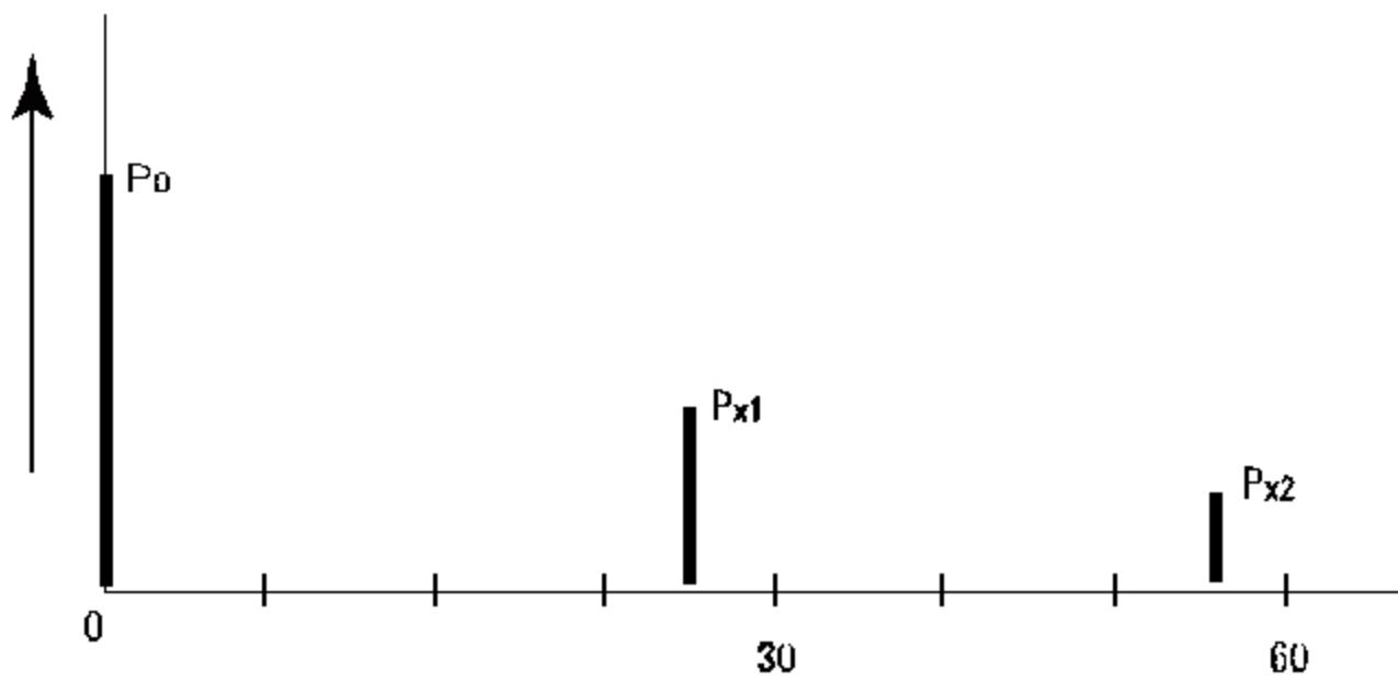
正如图 4 所示，当存在两个或者更多的频率构成 ( $P_0, P_{x1}, P_{x2}$ ) 时，在所有频率构成的最大值中 ( $P_{x1}, P_{x2}$  在图 4 的情况下)，除了频率为 0 的构成要件  $P_0$  外，都将使用  $P_x$  进行设置。运用 JEITA 法，闪烁度在这个范例中是使用以下公式进行计算的。
