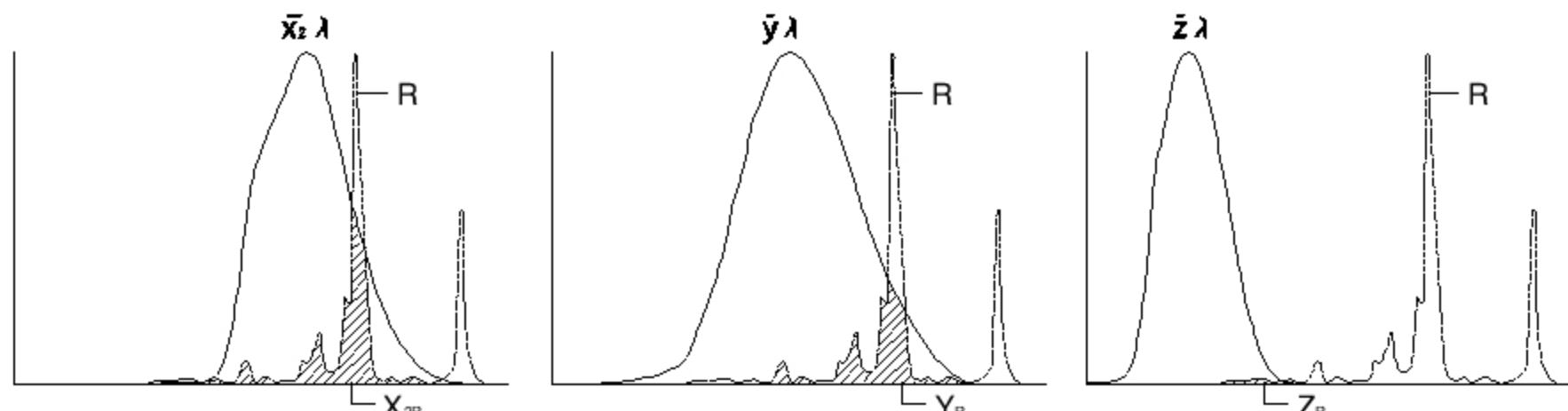
图 2. 由红色单色光放射的传感器  $\bar{x}_2\lambda$ ,  $\bar{y}\lambda$ ,  $\bar{z}\lambda$  的输出值
