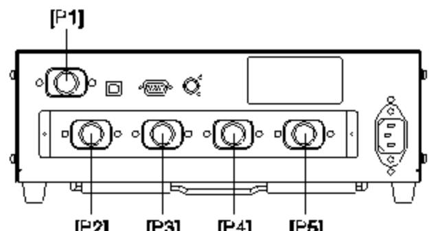
总共可以连接 5 个探头。如果要连接两个或者更多的探头，需始终确保其中一个要连接到连接器 [P1] 上。
