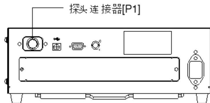
2. 将探头的插头插入探头连接器[P1]，并确保该探头的序列号正面朝下。
