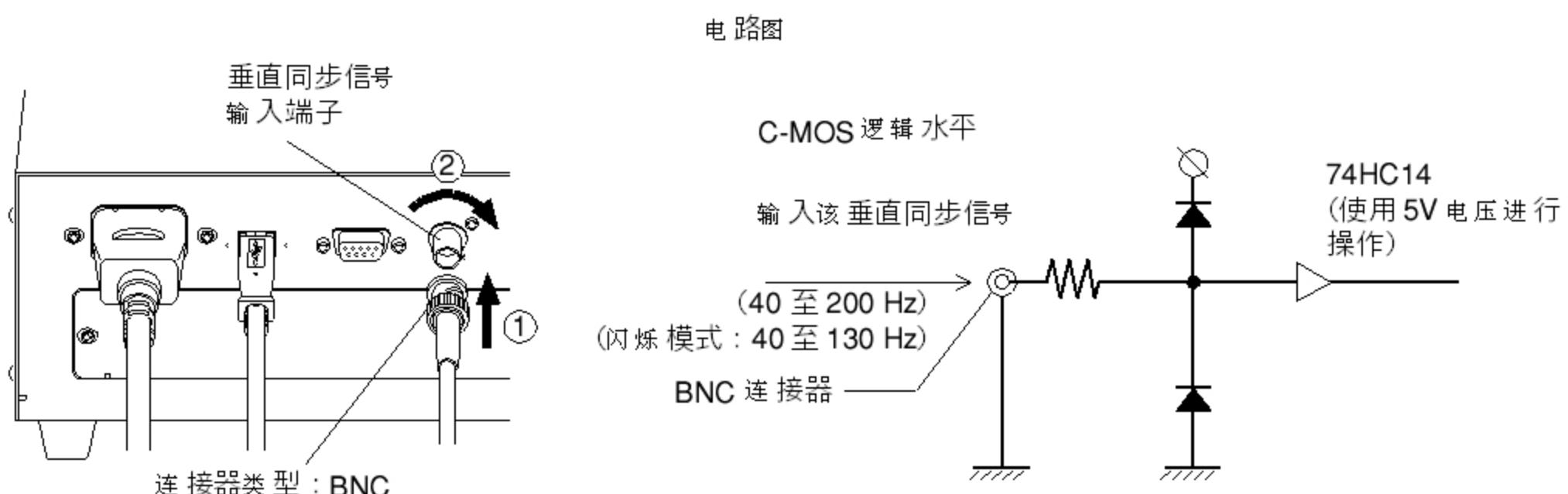
\* 使用显示器的垂直同步信号实施同步测量时，EXT 必须选择为同步模式。详情请参见第 38 页。
