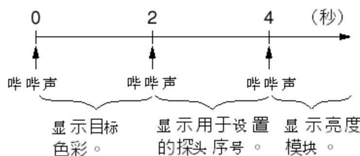
在设置时，检查测量探头序号，按下 **MR** 键两到四秒钟（两秒钟过去后，能听到哔哔声）并在液晶显示屏部分检查它。
