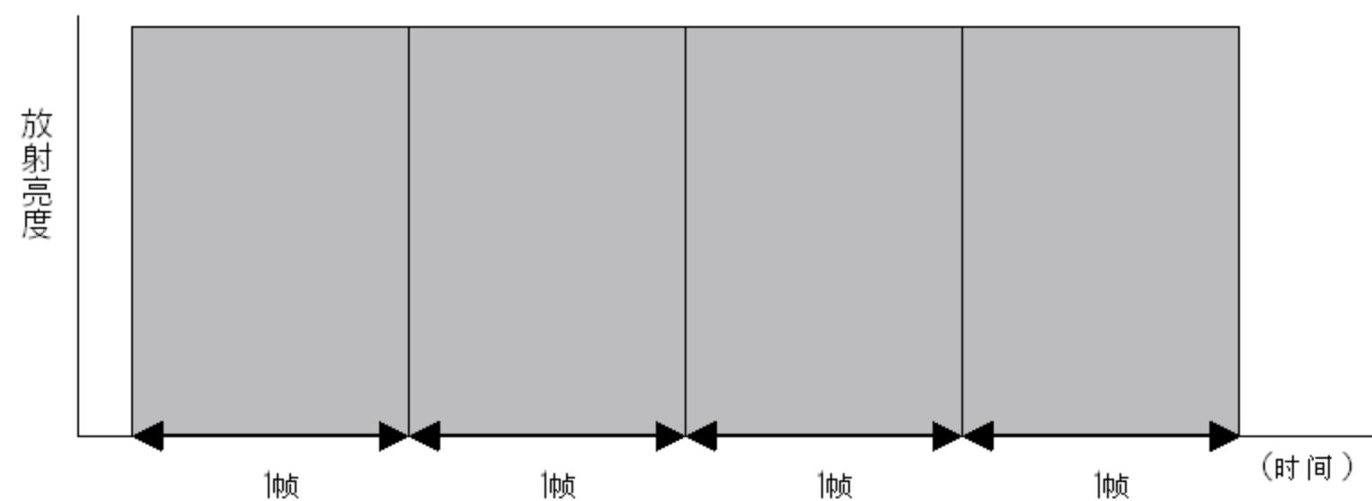
图 5-3 激活的矩阵液晶显示屏的放射特性
