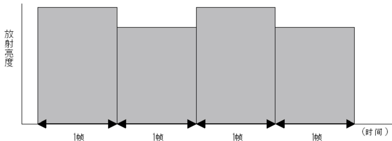
图 6 使用“闪烁”的液晶显示屏的放射状态
