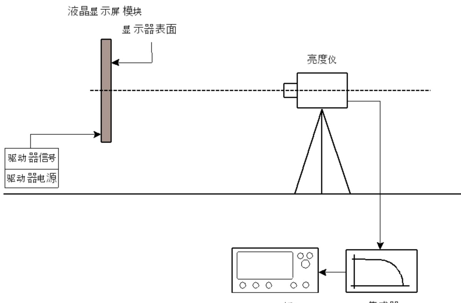
图 3 显示了从亮度仪（用于测量液晶显示屏）的输出信号引导到集成器中。
