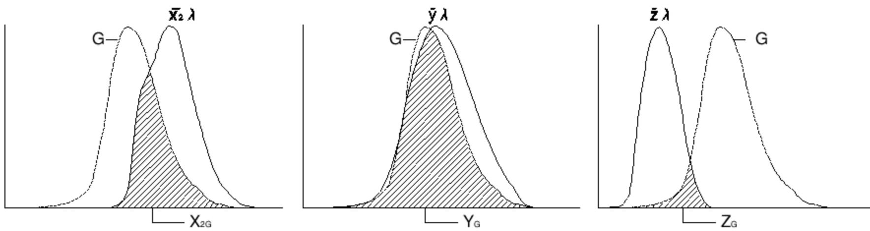
图3.由绿色单色光放射的传感器 $\bar{x}_2\lambda$ ,  $\bar{y}\lambda$ 和 $\bar{z}\lambda$ 的输出值
