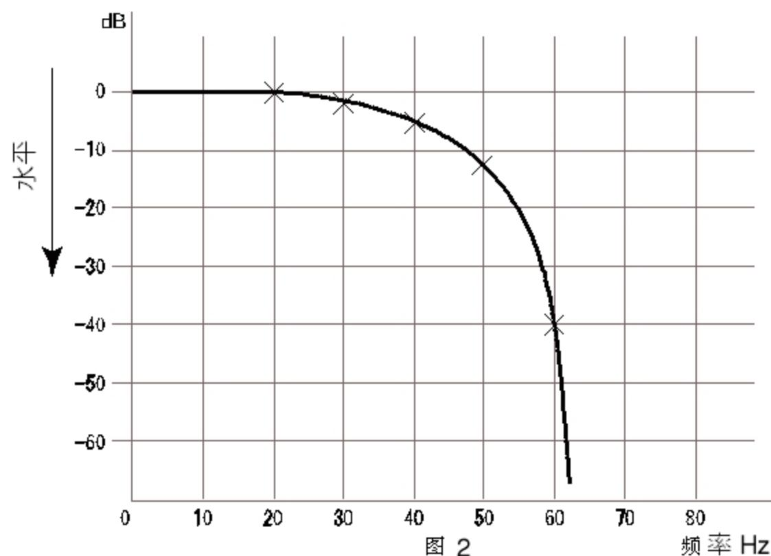
从该图可以看出，一个大的振幅和 60Hz 或者更高的频率是可能存在于人眼的，只是人类没有察觉这闪烁。因此，在闪烁测量中使用 JEITA 法时，知道闪烁能量精确的振幅和频率，以及另外由对比方法定义的 AC/DC 构成比率，是十分重要的。
