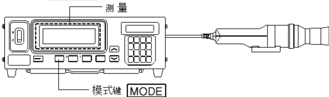
每次按下模式键 **MODE**，测量模式将按照以下显示的方式转换。
