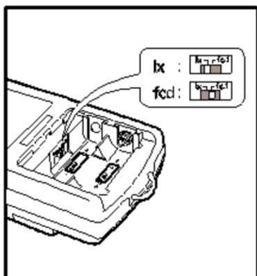
1. 将电源开关调至 "O"（关闭）处，然后轻轻按下并拉开电池盖板。
